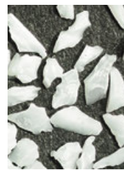
Nasyp ścierny pod mikroskopem
